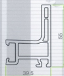
پایه قاب توری کشونی SI.Mosquito clip S-508.12 0,70 kg/m
