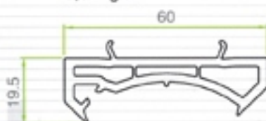
رابط پروفیل گوشه Bay&bow adaptor S-508.07 0,57 kg/m
